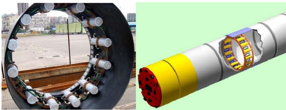
Fig 2-3 – Descrizione del metodo – Immagine di una stazione intermedia di spinta (da Herrenknecht website)
